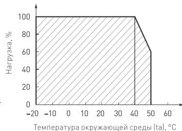
Рис. 4. Зависимость максимальной допустимой нагрузки, % от температуры корпуса
