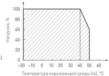
Рис. 4. Зависимость максимальной допустимой нагрузки, % от температуры корпуса
